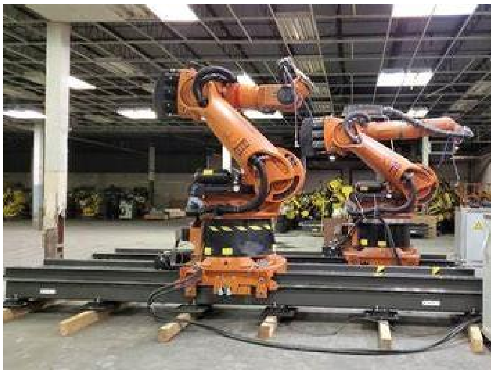
Figura 1. Braço mecânico e trilhos lineares do Kuka KR 360-3 KRC4 SOBRE TRILHOS LINEARES
