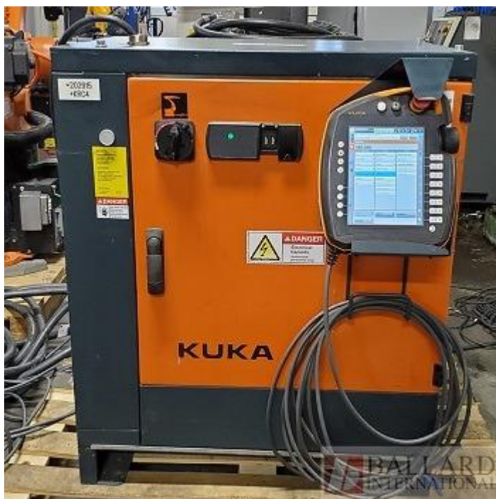
Figura 2. Painel de comando e unidade de controle e programação do Kuka KR 360-3 KRC4 SOBRE TRILHOS LINEARES
